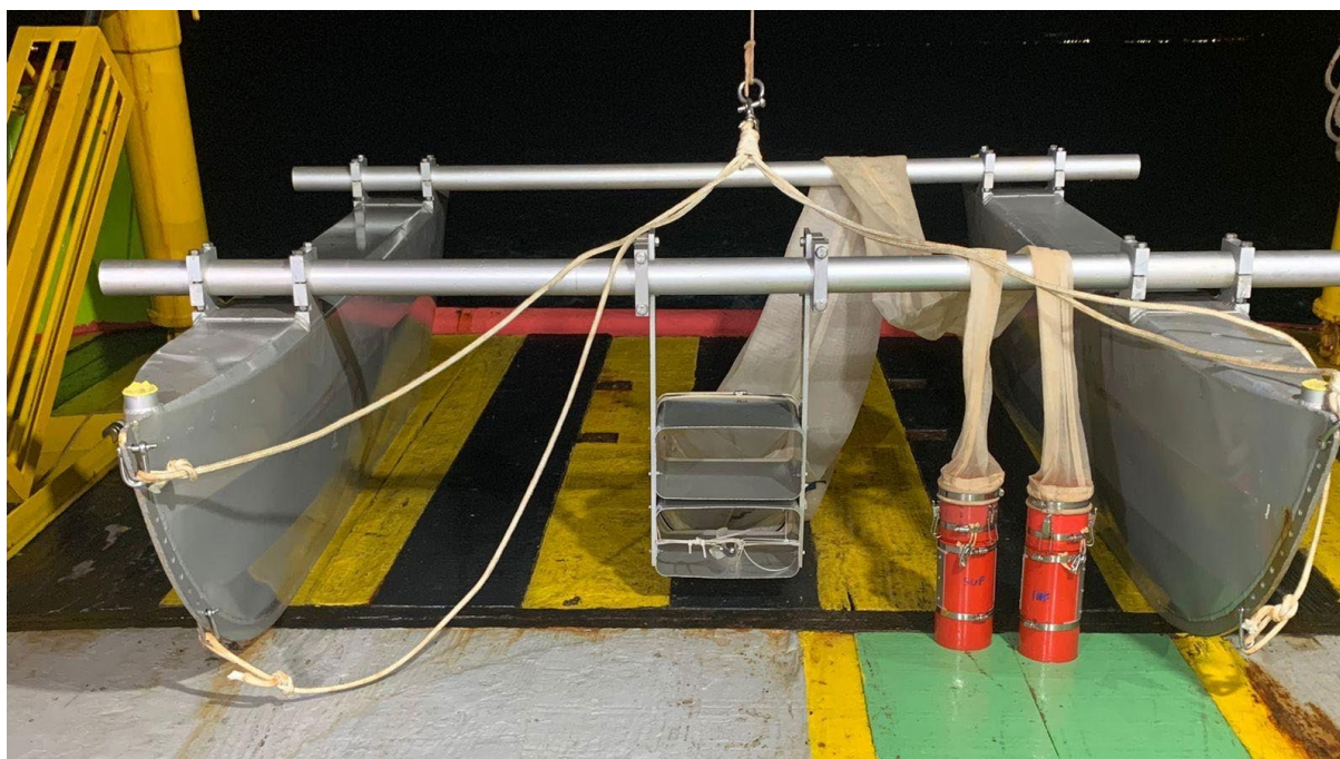
Figura 1: Rede neustônica utilizada nas amostragens subsuperficiais do ictioplâncton.
